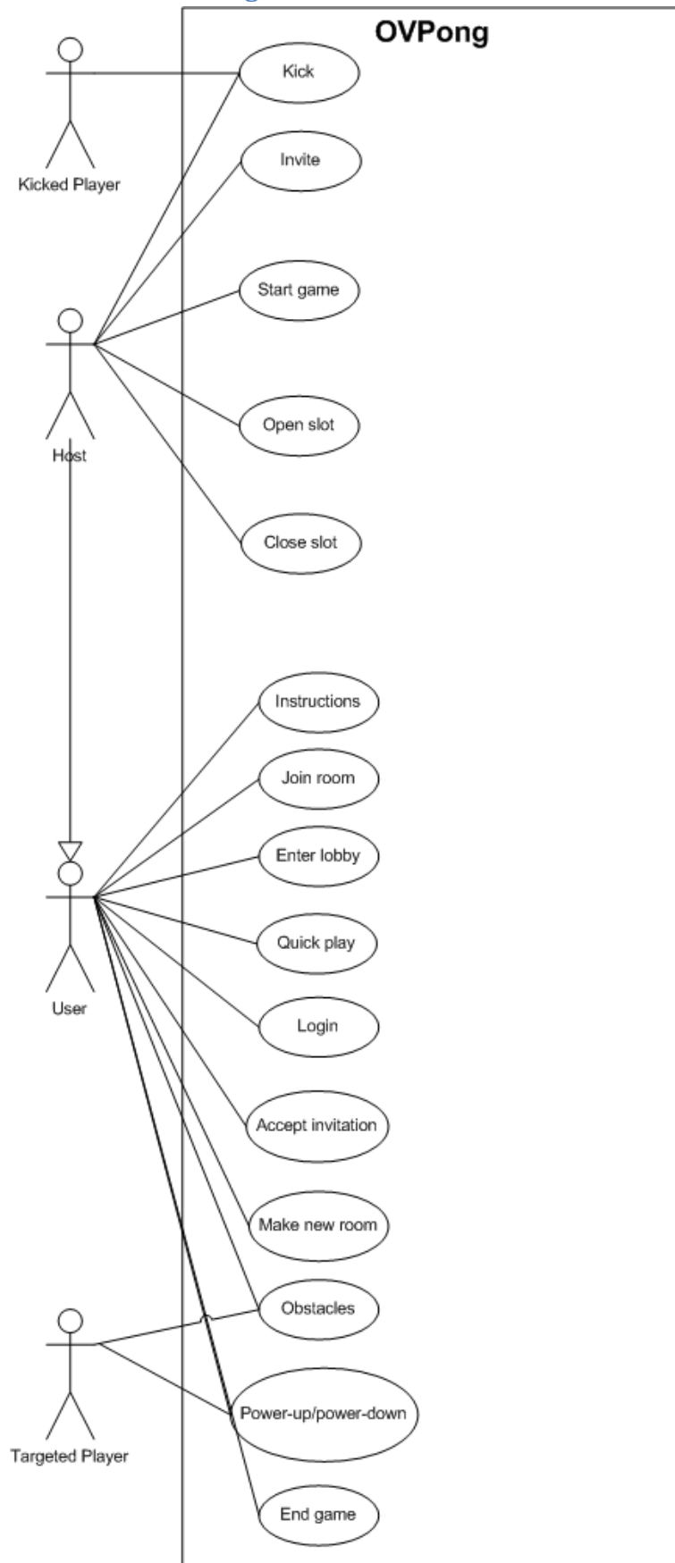
Figuur 17 - Use case diagram van het systeem
